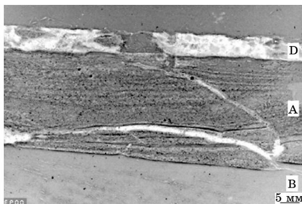
Рис. 12. Структура зони контактної взаємодії криці 130X17 після випробувань пари тертя у середовищі водна емульсія концентрату МОР «Сінтал-2»–повітря. Торцевий шліф, А — самоорганізовані зносостійкі покриття, В — деформований вихідний метал, D — хемічні сполуки продуктів розкладу МОР з металом поверхонь, що труться.
