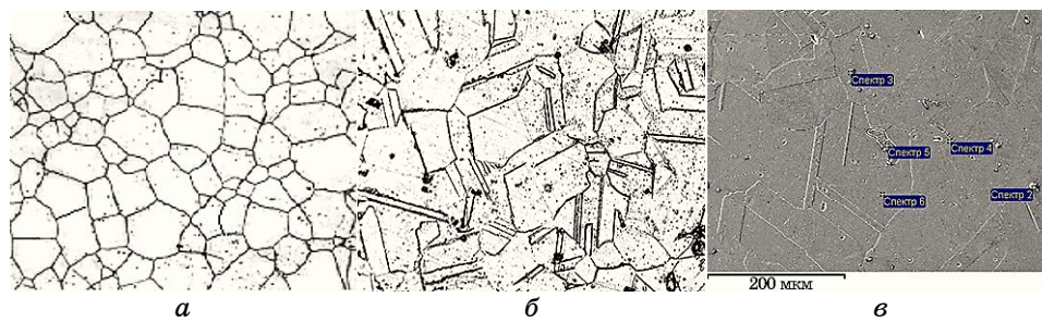
Рис. 5. Металографічне (а, б) й електронно-мікроскопічне (в) зображення структури типу ІІІ у придатному за УЗК виковку: щавлення шліфа для виявлення дійсного зерна ( \times 200 ) (а) та для виявлення МЗ ГПВ ( \times 300 ) (б).
