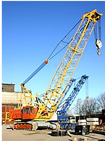
Рис. 1. Гусеничний кран із застосуванням гасителя коливань вантажу.
