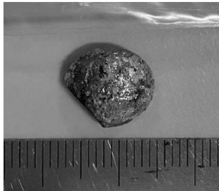
Рис. 3. Макрознімок зразка ВЕС, витопленого з дроту.
