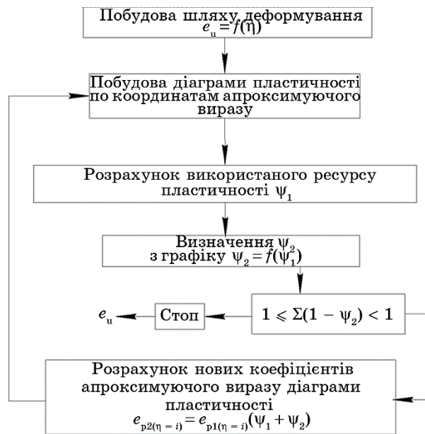
Рис. 6. Схема розрахунку гранично допустимого ступеня деформації за деформування з проміжним термообробленням.
