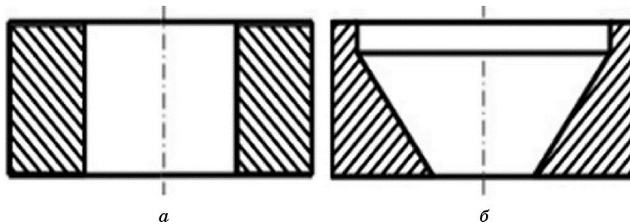
Рис. 1. Ескізи модифікувальних вставок, спресованих з порошку: циліндрична втулка (тип 1) (а), із внутрішнім конусом (діафрагма) (тип 2) (б).
