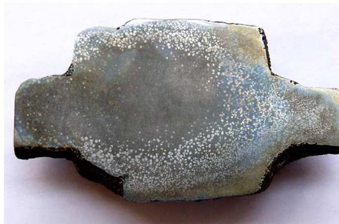
Рис. 3. Макроструктура ділянки ливника з модифікувальною вставкою після заливання розтопу.
