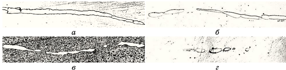
Рис. 9. Еволюція \delta -фериту в аустенітній Cr–Ni-криці під час тривалого високотемпературного відпалу ( \times 300 ): вихідна структура ( a ); 1150°C, 6 год ( б ); 1200°C, 6 год ( в ); 1200°C, 10 год ( г ).
