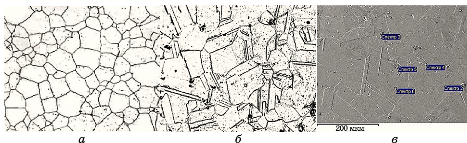
Рис. 5. Металографічне (а, б) й електронно-мікроскопічне (в) зображення структури типу ІІІ у придатному за УЗК виковку: щавлення шліфа для виявлення дійсного зерна ( \times 200 ) (а) та для виявлення МЗ ГПВ ( \times 300 ) (б).
